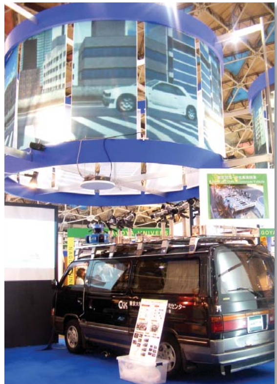
▲ 9台のカメラを搭載した実空間情報収集実験車
